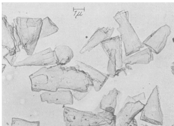
Abb. 2. Bayerit (Kegelfraktion), hergestellt durch Hydrolyse aus Aluminium-Äthylat. Übersichtsbild (elektronenmikroskopisch, Kohlenstoffhüllen), Vergrößerung: 5000fach
